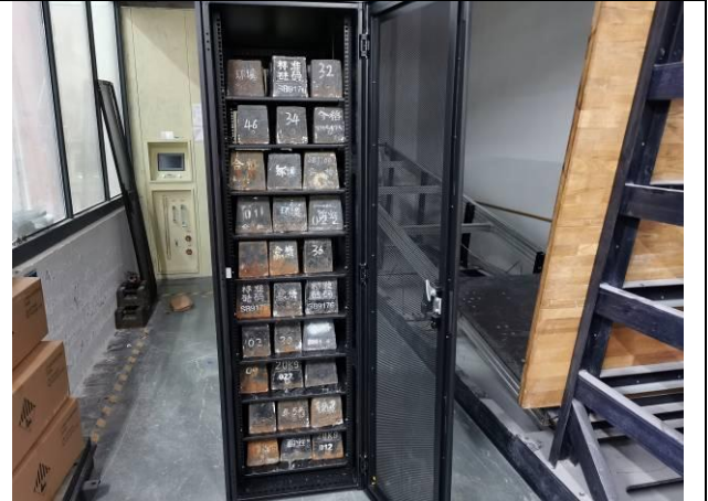
序号 4-2 机柜静态承重试验
